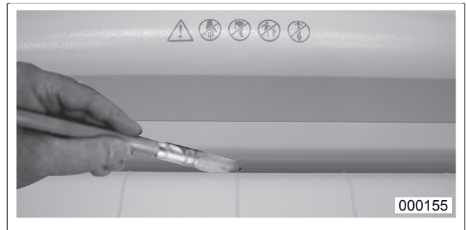
fig. 7 Nettoyage des cellules photoélectriques
