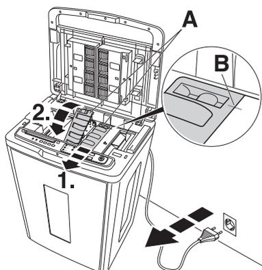
**PL** W przypadku, gdy kartki papieru nie są poprawnie pobierane przez paski podajnika (patrz strona 45), mimo iż zostały wcześniej oczyszczone, należy wyciągnąć cały zespół podajnika **(A)**. Do celów serwisowych lub w przypadku zacięcia papieru prosimy o wyciągnięcie zespołu podajnika **(A)**. Aby to zrobić należy:
