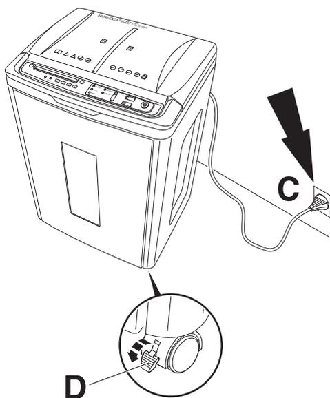
**SV** Ta ut avfallsbehållaren för CD-skivor (A) från nedre delen av förpackningen och placera den i avfallsbehållaren för papper. Skjut in avfallstunnan (B). Anslut väggkontakten (C). Använd de två hjulbromsarna (D) för att förhindra ofrivillig förflyttning!
