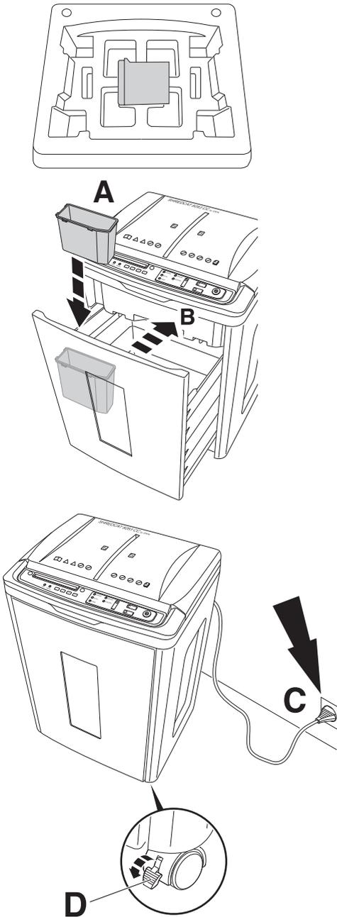
**DE** CD - Abfallbehälter (A) aus dem Unterteil der Verpackung nehmen und in den Papier - Abfallbehälter einstecken. Behälter einschieben (B), Stecker in Netzstecker (C) einstecken. Der SHREDCAT ist mit 2 feststellbaren Lenkrollen (D) vor dem Wegrollen zu sichern!
