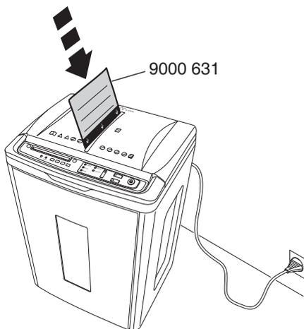
**DE** Bei nachlassender Schneidleistung oder nach jedem gefüllten Auffangbehälter Schneidwerk ölen! (siehe Bild)
