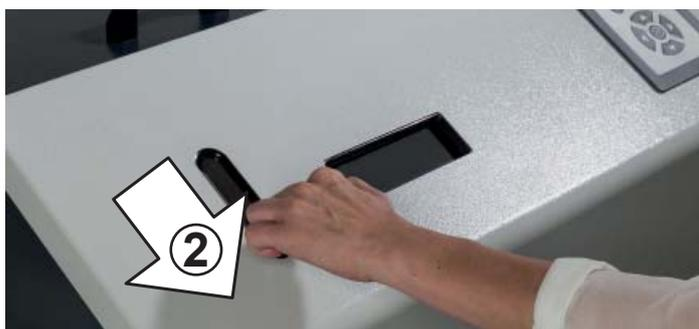
Mit dem Ziehen des Schiebers (2) wird das Material in das Schneidwerk abgeworfen.
