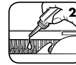
* יש למשוש שמן לרוחב וזן לסגור את המכסה. ללחוץ על הלחצן קדימה ולחזיקו במצב לחוץ במשך 2-3 שניות
